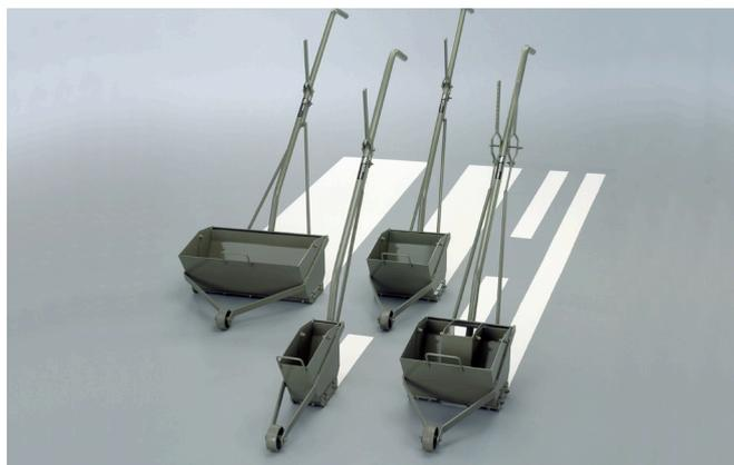
Les sabots de traçage manuel Borum peuvent servir au marquage d'une ligne allant de 10 cm jusqu'à 60 cm ou d'une double ligne de 10 cm et cela, en un seul passage. L'épaisseur de la ligne peut aller de 1,5 mm à 5 mm. Un produit antidérapant peut être prémélangé afin de rendre le marquage moins glissant.
